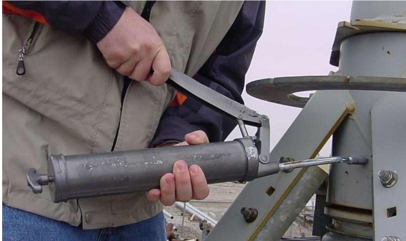
CUATRO ACCIONAMIENTOS POR ALEMITE SUELEN SER SUFICIENTES.
